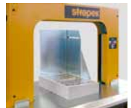
Paketanschlag zum Ausrichten von losen Bündeln
