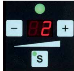
Vannekireys helposti säädettävissä painonapilla
